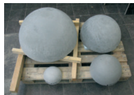
Probekörper aus selbstverdichtendem Beton (Größtkorn d = 4 mm)
