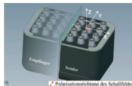
Gruppenstrahler (Scherwellen) mit 24 Einzelprüfköpfen
