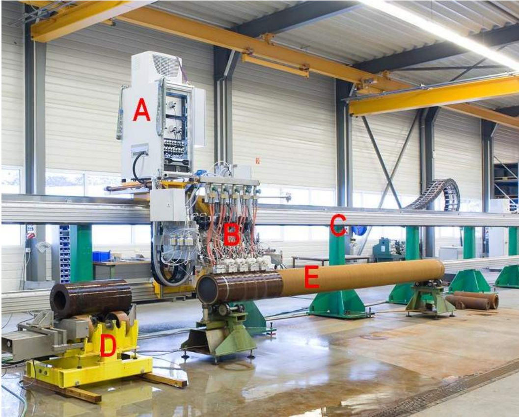
Abbildung Prüfanlage. Foto der Prüfanlage vor der Auslieferung. A = Prüfelektronik, B = Prüfkopfhalter, C = Prüfportal, D = provisorische Kalibrierstation und E = Produktionsrohr mit Testfehlern.
