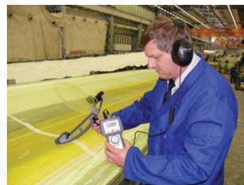
Dichtheitskontrolle an GFK Formen mit dem SONAPHONE
