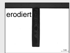
KSR 1 mm, erodiert mit Drahtrotation
