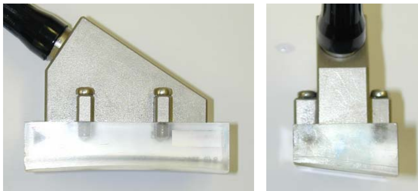
Bild 4. Prüfkopf mit Vorsatzkeil, links: Seitenansicht (Krümmung), rechts: Frontansicht (Dachwinkel)
