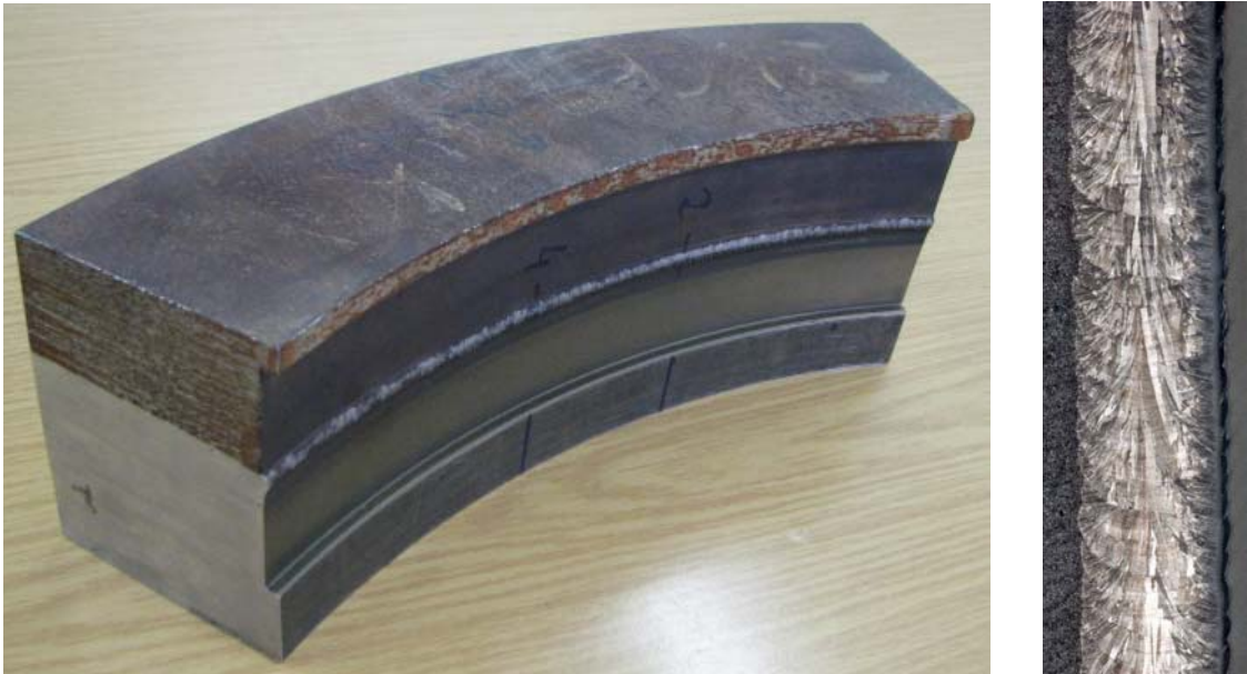
Bild 1. Prüfgegenstand, links: Gesamtansicht, rechts: Schliffbild der Engspaltschweißnaht
