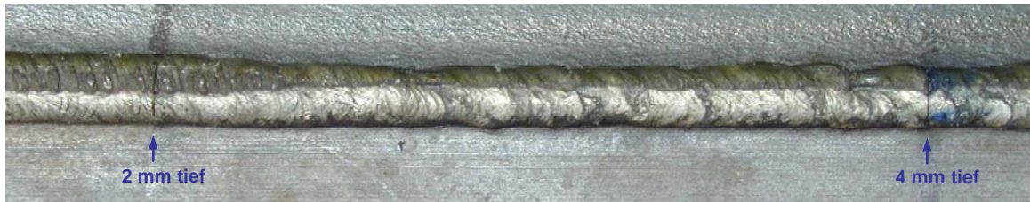
Bild 3. Nuten in der Schweißnahtwurzel
