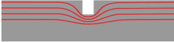
Abbildung 7: Schematische Verteilung des Wirbelstroms in austenitischem Stahl
