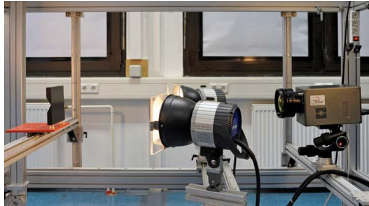
Abbildung 5. Messaufbau. Die Erwärmung erfolgt mit 2 Blitzlampen der Firma Hensel Studiotechnik, welche den Probekörper kurzzeitig um mehrere K erwärmen. Die Abkühlung wird mit der InSb-Kamera 640 SM von Thermosensorik aufgenommen.
