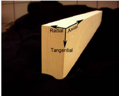
Abbildung 1: Wachstumsrichtungen, veranschaulicht am Probekörper aus Kiefer
