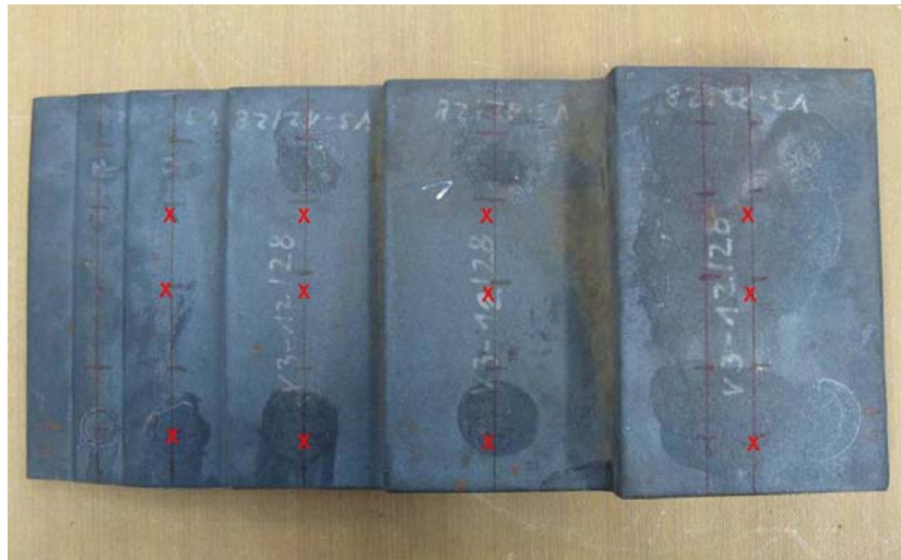
Bild 3: Stufenkeil (Abmessungen: 260 x 190 mm) mit Messstellen
