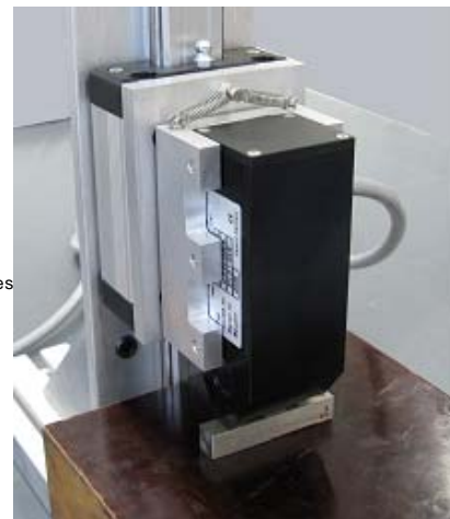
Bild 11: Sensorkopf in federnder Aufnahme
