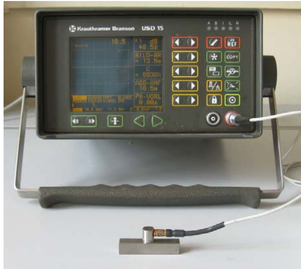
Bild 5: Ultraschall-Geschwindigkeitsmessung an prismatischen Proben mit USD 15 und dem Longitudinalwellen-PK CLF 5 bei 10 MHz in Impuls-Echo-Technik unter Auswertung des HF-Signals bei Triggerung auf die Signalspitze. Probenabmessungen 10x10x55 mm, Messung der Probendicke mit Digimicro MFC-101.
