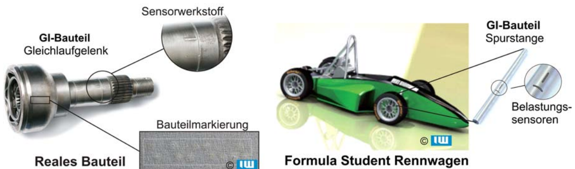
Bild 1. Belastungsempfindliche Gentelligente Fahrwerkskomponente: Gleichlaufgelenk, Spurstange
