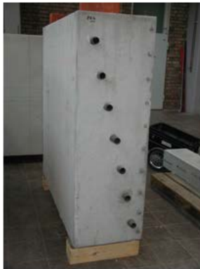
Abbildung 2 Probekörper mit Messlinien und Messfeld, Probekörper A: Beton (1,50 m x 1,50 m x 0,50 m) mit Stahlrohren (Außen-Ø 43 mm, Wandstärke 2 mm) und einer Bewehrungsmatte (Ø 12 mm, Abstand 15 cm); Probekörper B: Beton (1,50 m x 1,50 m x 0,30 m) mit Stahlstäben (Ø 16 mm) und einer Bewehrungsmatte (Ø 12 mm, Abstand 15 cm).
