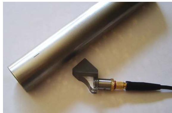
Abb. 2. Prüfkopf für die Längsfehlerprüfung
