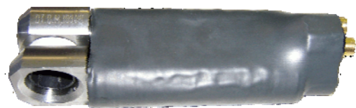
Abb. 8. Wirbelstromsensor mit Magnetisierungsspulensystem
