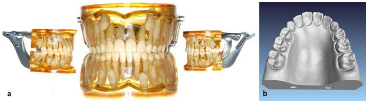
Abbildung 1. Das Acryl-Schaummodell (a) wurde mittels der hochauflösenden \mu CT-Forschungsanlage Mikrofokus 3D-CT digitalisiert und als Referenzmodell (b) für die Genauigkeitsbestimmung herangezogen
