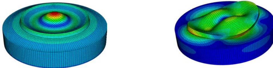
Bild 7. FEM-berechnete Moden auf einer PMMA-Platte: links Biegemode, rechts Radialmode
