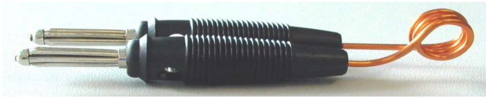
Abb. 7. Spulenanordnung für ein Beobachtungsfeld von ca. 5 mm Durchmesser.
