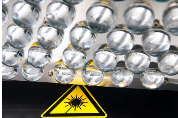
Abb. 4. LED-Array mit Einzellinsen zur Erzielung einer hohen Leistungsdichte auf einer nutzbaren Fläche von ca. 2 cm 2 .
