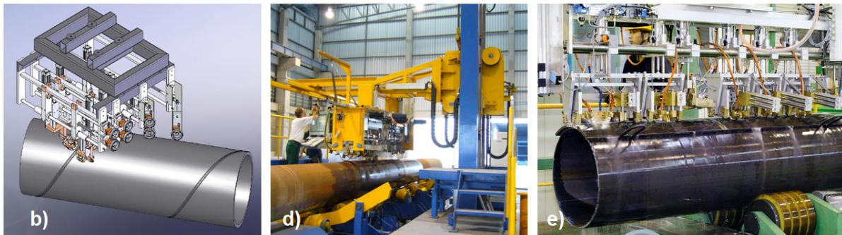
Bild Prüfung UP-geschweißter Großrohre. a) Prinzip der Schweißnahtprüfung mit 10 Prüfköpfen (4 für Längsfehler, 2 für Querfehler auf der Naht, 4 für Dopplungsprüfung neben der Naht), b) zugehörige Prüfmechanik als 3D-CAD-Zeichnung, c) Prinzip der Schweißnahtprüfung am längsnahtgeschweißten Großrohr mit 22 Sensoren (L = Längsfehler, T = Tandem, Q = Querfehler, D = Dopplungen, S = Nahtverfolgung), d) zugehörige Prüfmechanik in Auslegerbauweise, e) Seitenansicht der Prüfkopfhalterungen (zusätzlich erkennbar ist eine Rohrschale, die für die Kalibrierung der Anlage auf das Produktionsrohr gelegt wurde).
