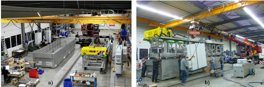
Bild Endmontage einer Tauchtankanlage a) Blick in die Halle des Sondermaschinenbaus in Wuppertal, b) Einsetzen der Drehrollenstation in den Edelstahltank unter Verwendung eines Schwerlast-Kranwagens.
