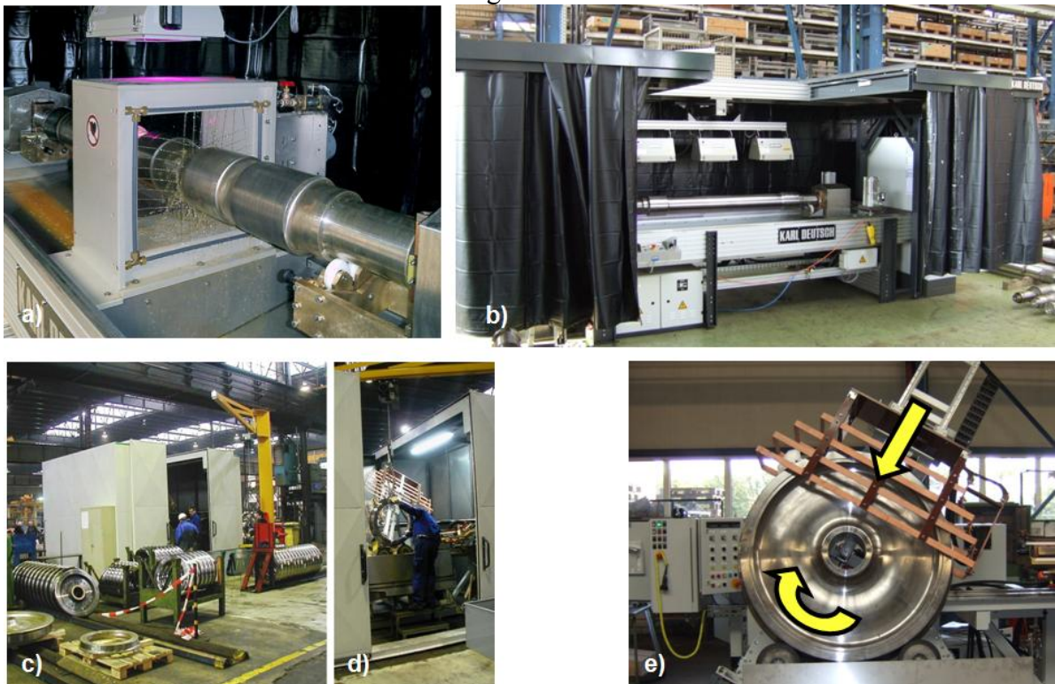
Bild MT-Prüfung von Eisenbahnteilen. a) Prüfung von Eisenbahnwellen mit Überlaufspule, b) Gesamtansicht der Prüfanlage mit pneumatisch beweglichem Dach zur Kranbeladung, c) Prüfkabine für Eisenbahnräder mit Kran, d) Beladung der Prüfanlage mit einem Radreifen, e) Prüfung eines Eisenbahnwagens unter Rotation des Bauteils und unter Verwendung einer Hochstromspule, die pneumatisch in die Prüfposition bewegt wird.
