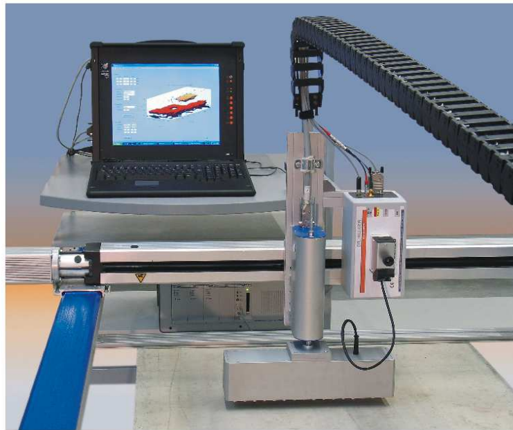
Bild 5: Flexus Beton: Scanner mit Prüfkopf-Array und aktivem Multiplexer sowie dem Ultraschallprüfsystem USPC 3041
