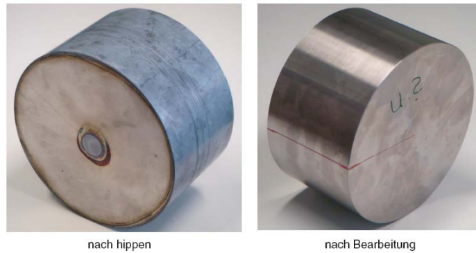
Abbildung 11: Erster Ultraschall-Testkörper mit eingebrachten Fehlstellen nach dem „Hippen“ (links) und nach anschließender Oberflächenbearbeitung (rechts).
