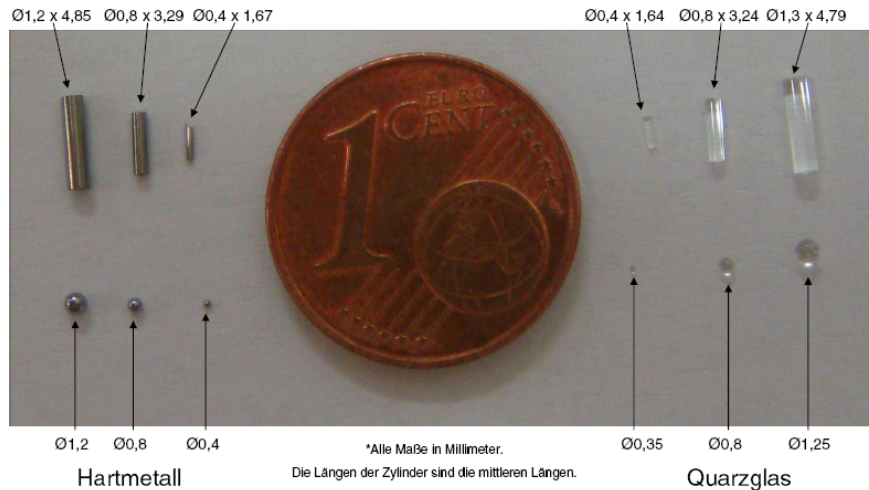
Abbildung 9: Künstliche Hartmetall- und Quarzglas-Einschlüsse zum Einbau in POD-Titantestkörper.
