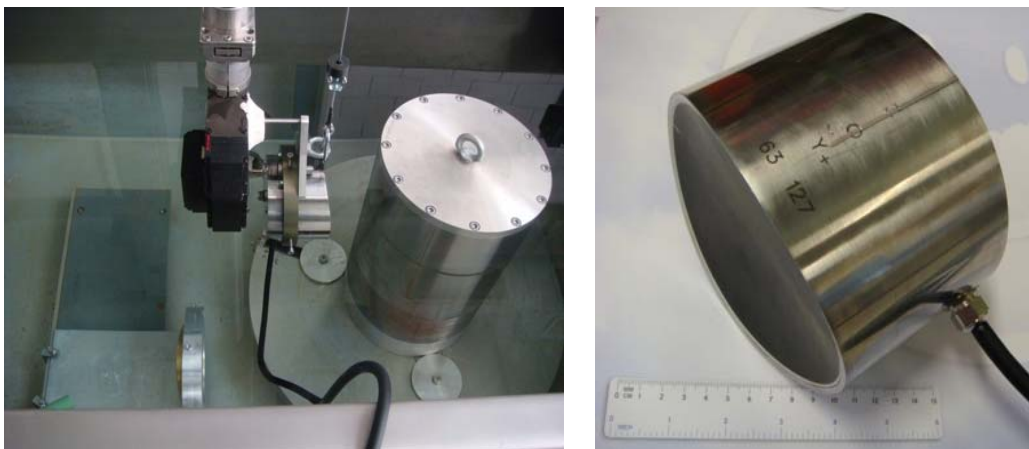
Abbildung 8: Automatisierte Ultraschallprüfung von Titan-Billets (links) mit Hilfe von speziellen Phased Array-Prüfköpfen mit Fermat-Fläche (rechts).
