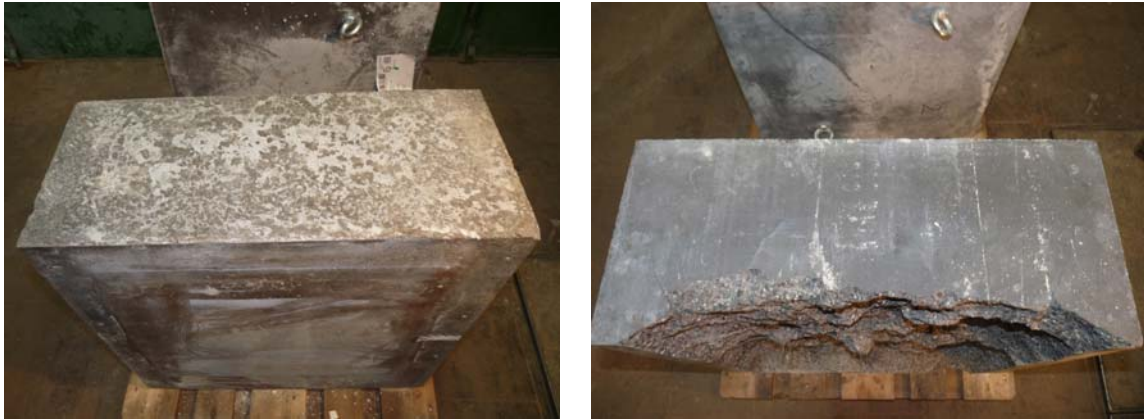
Abb. 4: Links: HPC Probekörper mit 1 kg/m 2 PP-Fasern nach den Brandversuchen. Rechts: Schädigung aufgrund von explosiven Abplatzung an einem Probekörper ohne PP-Fasern.
