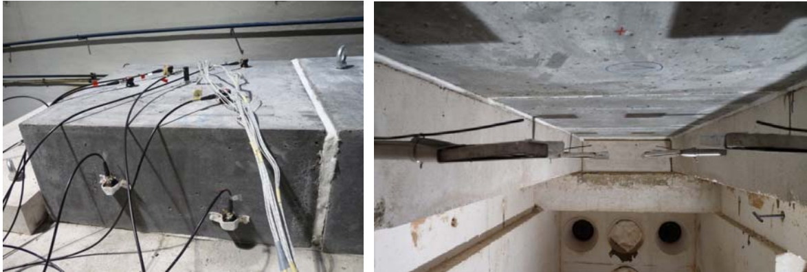
Abb. 2: Links: Oberseite eines der HPC Probekörper mit Schallemissionssensoren. Rechts: Innenansicht des Prüfofens vor dem Experiment mit der brandbeanspruchten Unterseite der Probekörper, der Temperaturmesstechnik und den Brenneröffnungen.
