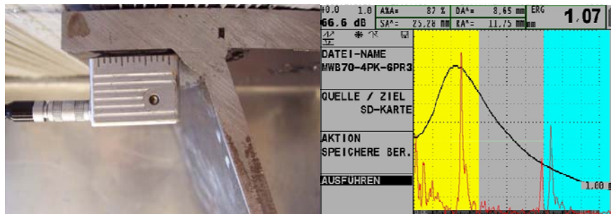
Abb. 8. Ultraschallprüfung der Schweißverbindung zwischen Trapezsteife und Deckblech mit einem 70°-Winkelprüfkopf. Ein fortgeschrittenes Risswachstum, das hier durch eine gefräste Nut modelliert wurde, lässt sich feststellen.
