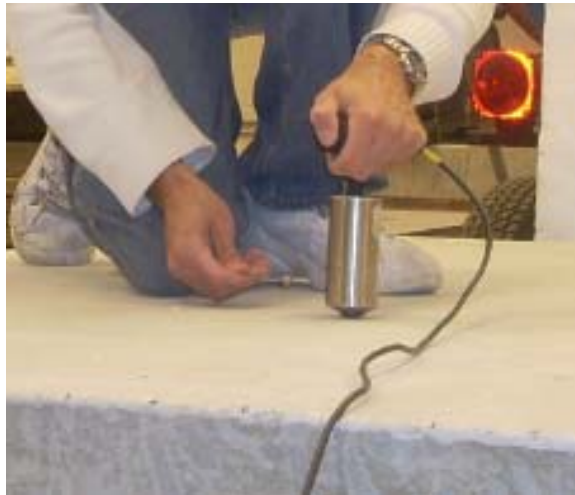
Abbildung 2: Manuelle Impact-Echo-Messungen mit herkömmlichem Kontaktsensor
