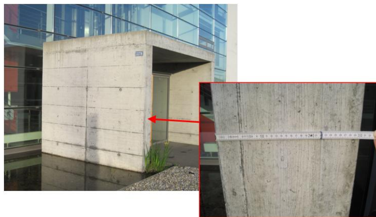
Abbildung 7: Testwand aus Beton mit einer Dicke von d = 30 cm. Alle Messungen wurden in ungestörten Bereichen, d.h. Bereichen ohne Einbauten wie beispielsweise Entwässerungsröhren durchgeführt.
