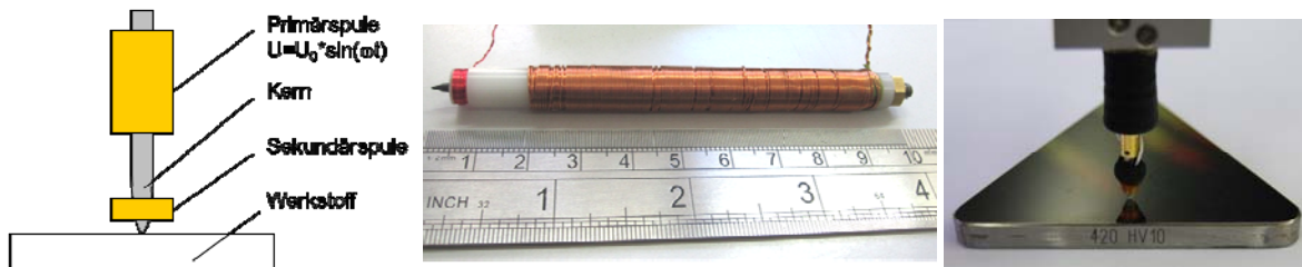
Abbildung 4: Schematischer Aufbau einer Punktsonde (links), Foto eines Realisierungsbeispiels aus dem Labor (Mitte) und 3MA-Punktsonden-Prüfkopf (rechts)
