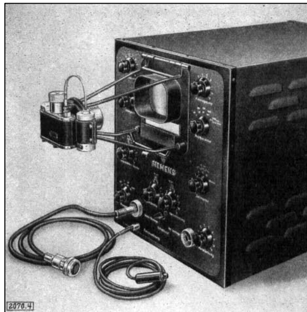
Abbildung 2. Links: Sperry Reflectoscope von ca. 1945. Rechts: Siemens Reflectoscope von ca. 1950 [3].
