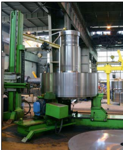
Abbildung 9. Automatisiertes Prüfungssystem das seit 1995 bei Saarschmiede zur Prüfung schwerer Schmiedeteile verwendet wird.
