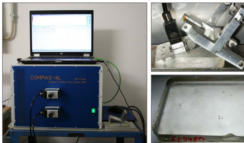
Abb. 13 Gruppenstrahler Gerät COMPAS XL (links), Matrixarray 2,25 MHz mit 10x6 Elementen (rechts oben), Prüfobjekt Vergußmasse mit eingebetteten Stahlkugeln (rechts unten)
