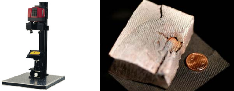
Abb. 2 Links: optisches Messsystem ATOS II SO wie auf der 'gom' Website abgebildet [11]; rechts: Streifenprojektion auf der ferritischen Schweißnahtprobe 'Greifswald'.
