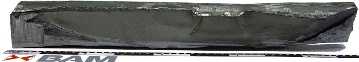
Abbildung 4. Bruchfläche eines Ermüdungsrisses ohne korrosiven Einfluss
