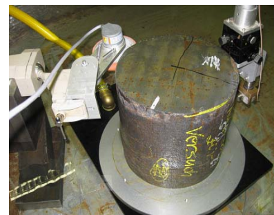
Abb. 11: Einschallschema bei der Stabstahlprüfung in Tauchtechnik
